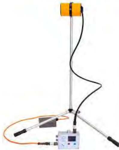
Рис.1.12. Магнітометр на основі ефекту Оверхаузена
