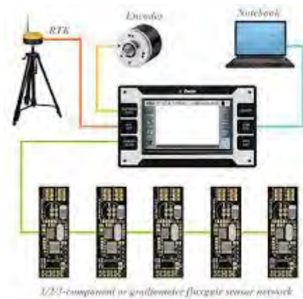
Рис.1.13. Схема магнітометра градієнтометра
