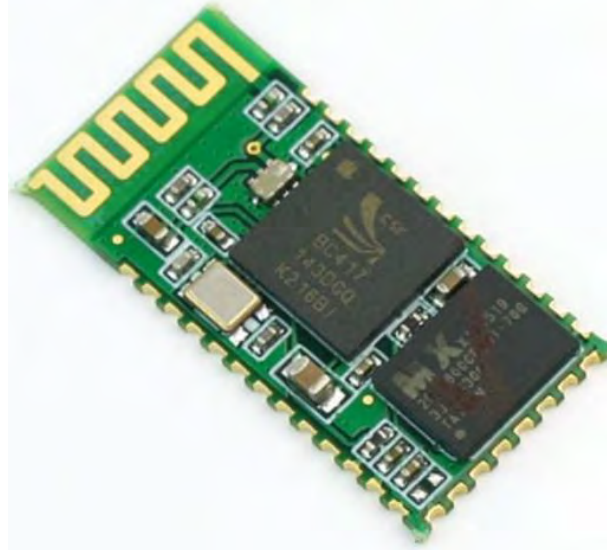
Рис. 3.6 Датчик Bluetooth модуля HC-05
