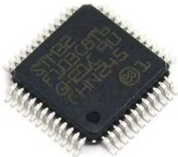
Рис. 3.4 Загальний вигляд мікроконтролера STM32F103C8T6
