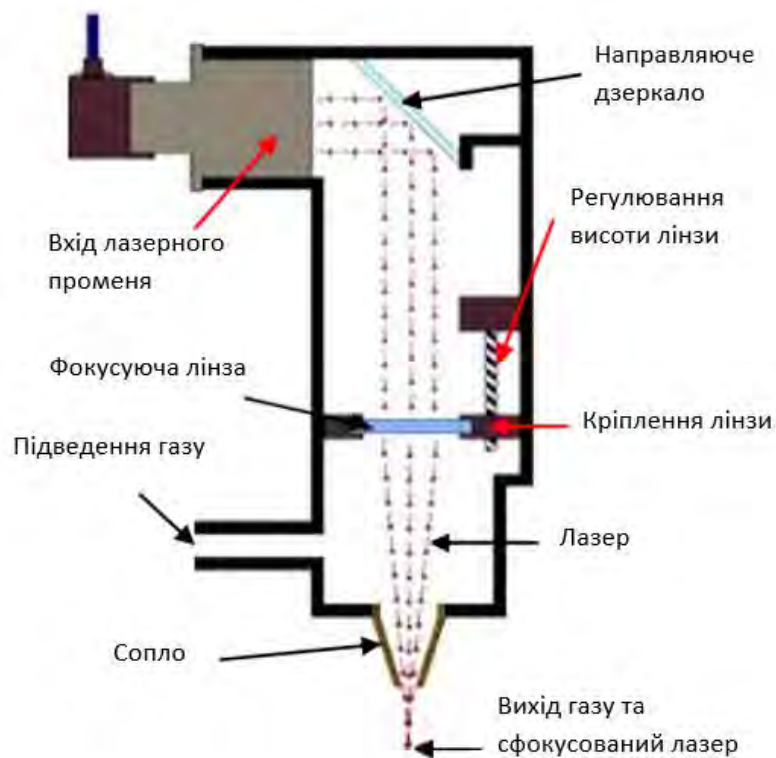
Рисунок 3.3 - Конструкція лазерної головки [32]
