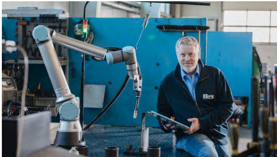
Рис.1.6. Кобот UR12e та оператор з пультом керування [8].
