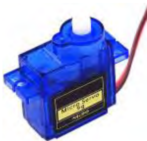
Рис. 2.4. Сервопривід Tower Pro SG90 2кг 180° [21].
