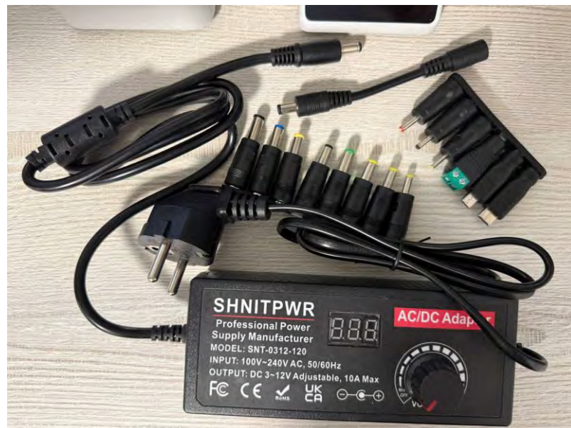
Рис. 2.3. Блок живлення SHNITPWR SNT-0312-120.
