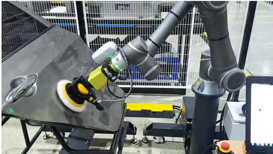
Рис.1.8. Кобот TM12S на виробництві виконує полірувальні роботи [12].
