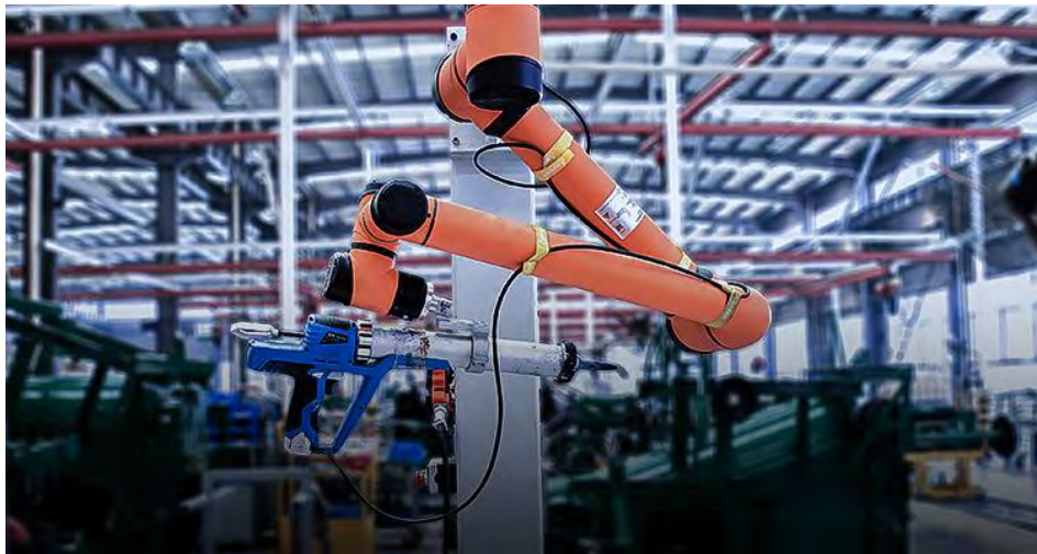
Рис.1.11. AUBO-i10 на виробництві, тримає електричний пістолет для нанесення клею або герметика [16].
