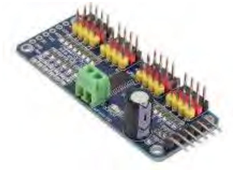
Рис. 2.2. Модуль управління сервоприводами PCA9685 [20].
