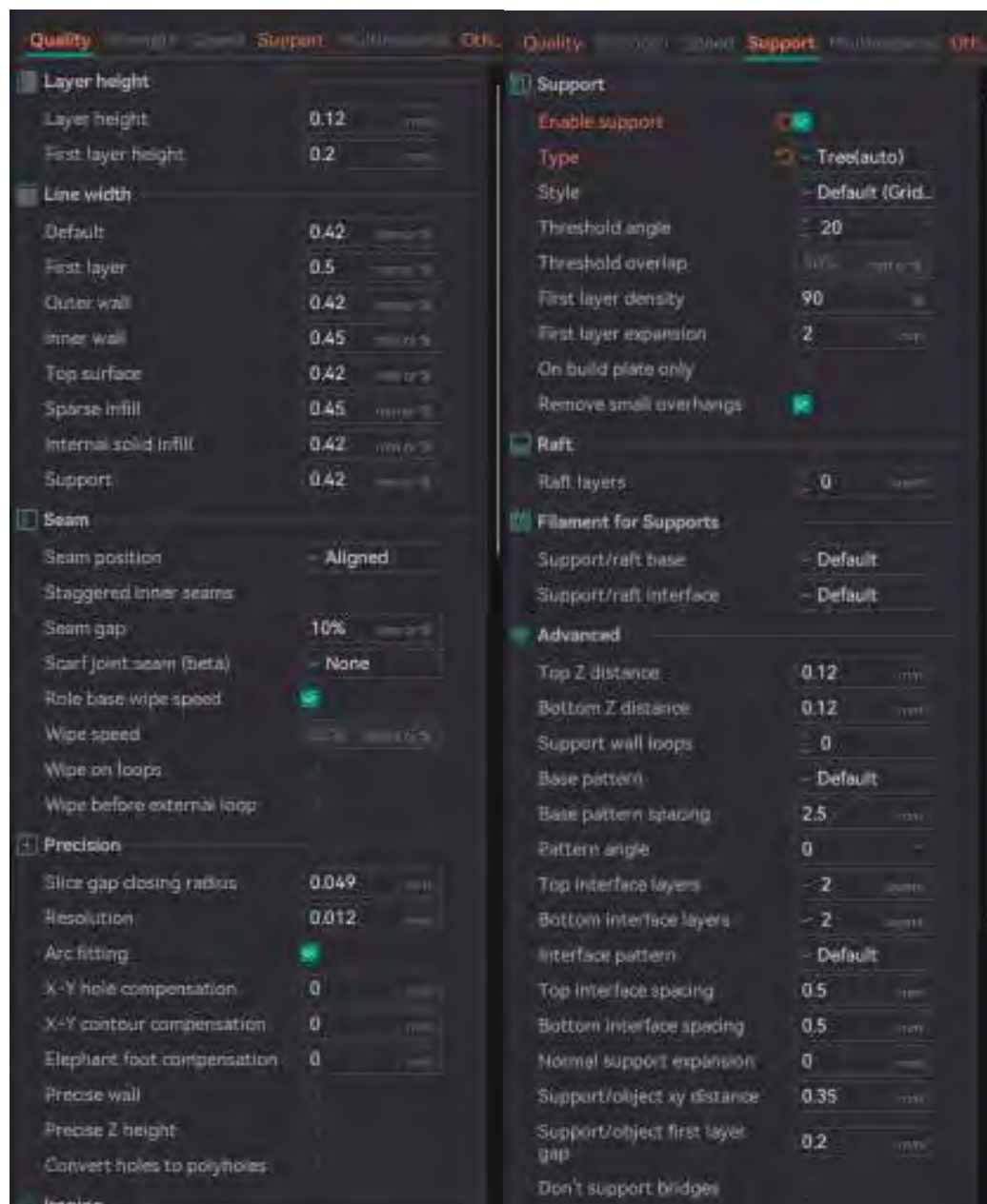
Рис.4.4. Опис налаштувань якості (рис. а) та налаштувань підтримок (рис. б)
