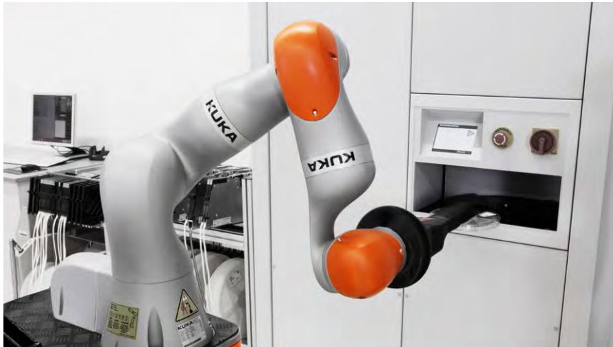
Рис.1.10. LBR iiwa 14 R820 на виробництві електроніки [15].
