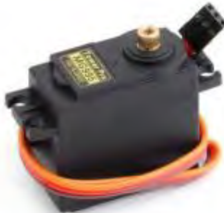
Рис. 2.5. Сервопривід Tower Pro MG995 180° [22].
