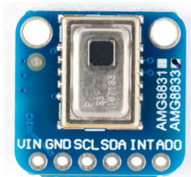
Рисунок 2.1 Інфрачервоний матричний детектор AMG8833
