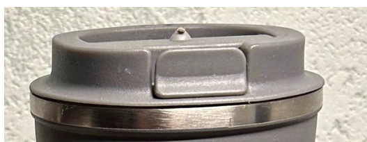
Рисунок 4.15 Металеve кільце термочашки яке має найбільшу теплопровідність
