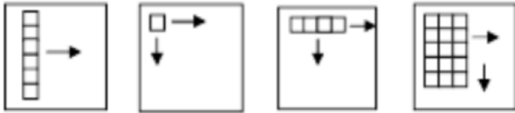
Рисунок 1.4. Методи сканування. а – метод паралельного сканування; б – послідовно-одноелементний; в – послідовно-лінійний метод; г – послідовно-паралельний.
