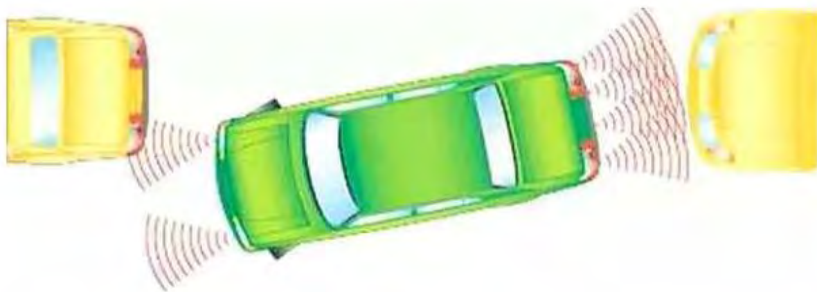
Рисунок 6 - Приклад парктроніка, що використовує датчики відстані
