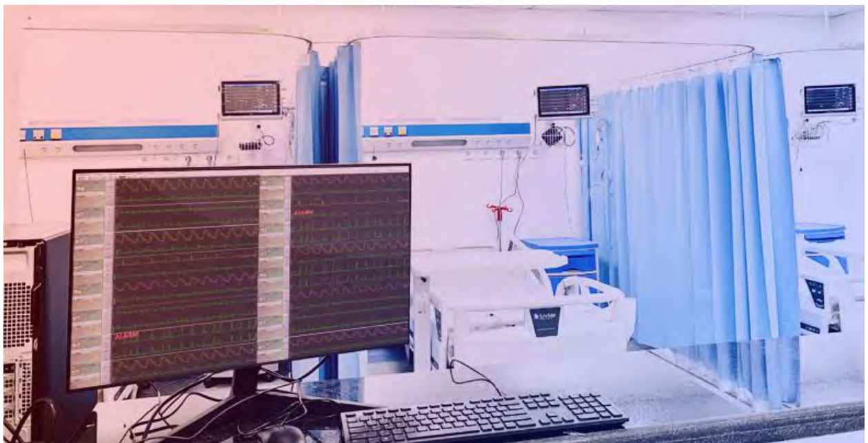
Рис 1.3. Центральна станція моніторингу системи важливих показників пацієнта
