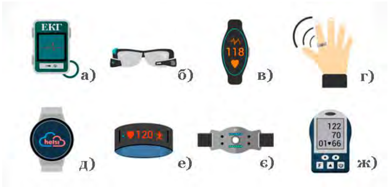
Рис 1.2. Приклади носимих пристроїв. а) ЕКГ-пристрій, б) Розумні окуляри, в) Фітнес-браслет із монітором серцевого ритму, г) Розумне кільце, д) Смарт-годинник, е) Спортивний фітнес-трекер, є) Датчик для моніторингу фізіологічних показників (пояс), ж) Глюкометр.
