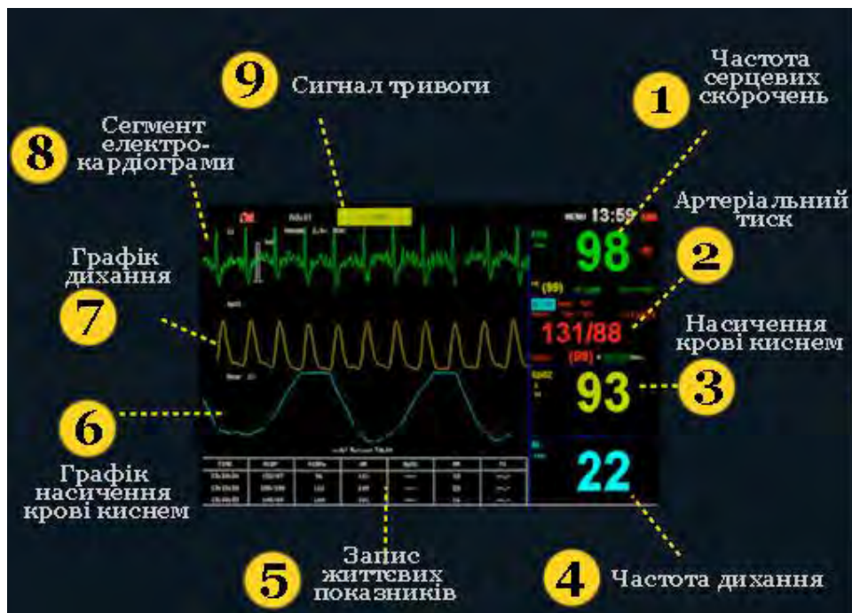
Рис 2.2. Екран медичного монітора для спостереження за життєвими показниками пацієнта. 1 - Частота серцевих скорочень, 2 - Артеріальний тиск, 3 - Насичення крові киснем, 4 - Частота дихання, 5 - Запис життєвих показників, 6 - Графік насичення крові киснем, 7 - Графік дихання, 8 - Сегмент електрокардіограми, 9 - Сигнал тривоги.
