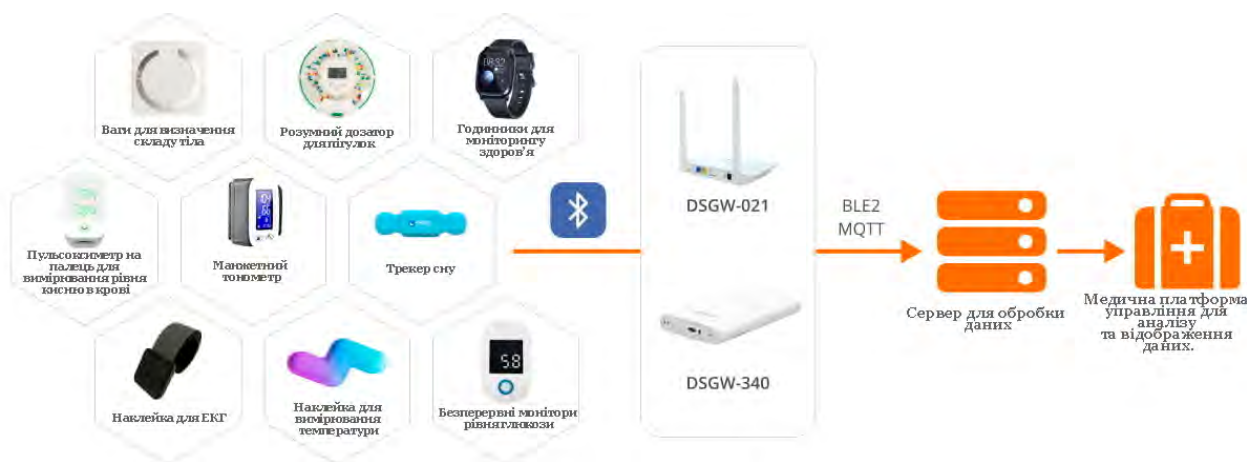
Рис 1.5. Схема віддаленого моніторингу пацієнтів IoT
