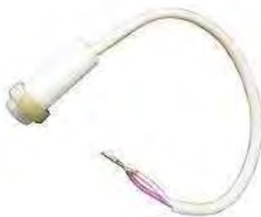
Рис 2.7. Датчик для безперервного моніторингу рівня глюкози
