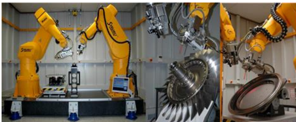
Рис.3.8 Застосування команди роботів для випробувань на РНК
