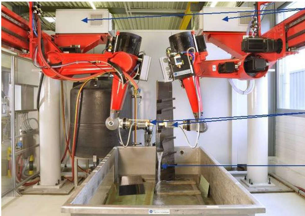
Рис.3.6 Синхронізований робот, який використовується для ультразвукового НК
