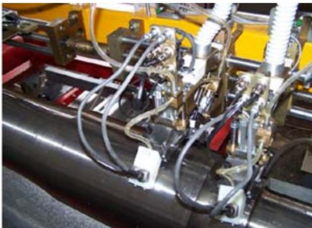
Рис.2.2. Сканування поверхні осі ультразвуковими перетворювачами
