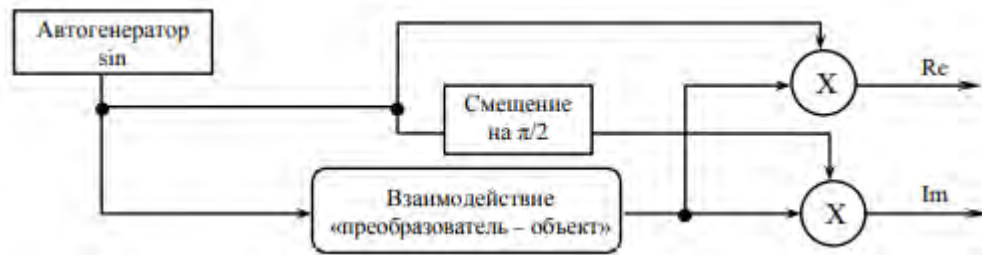
Рис. 2.6 Класична схема розподілу сигналу
