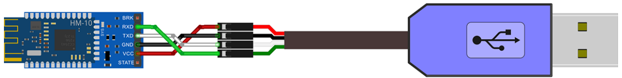
Рисунок 34. Розпіновка кабелю для підключення HM-10 до ПК
