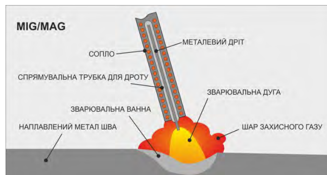
Рис.1.3. Процес MIG-зварювання
