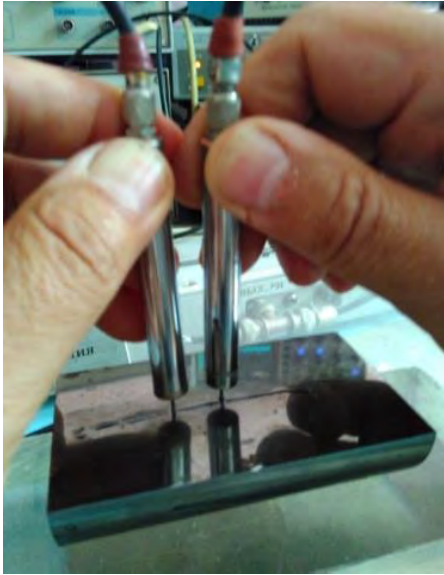
Рис. 2.10. Розташування МСП на ОК (а) та осцилограма сигналів МСП-приймача
