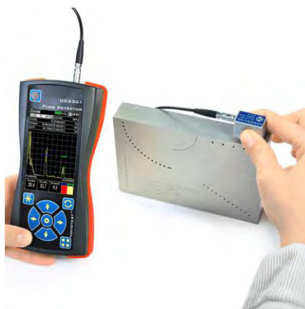
Рис.1.5. Прилад і тестовий зразок для ультразвукового неруйнівного контролю
