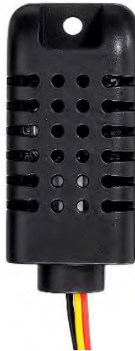
Рисунок 3.7. Датчик температури та вологості DHT21 [14]
