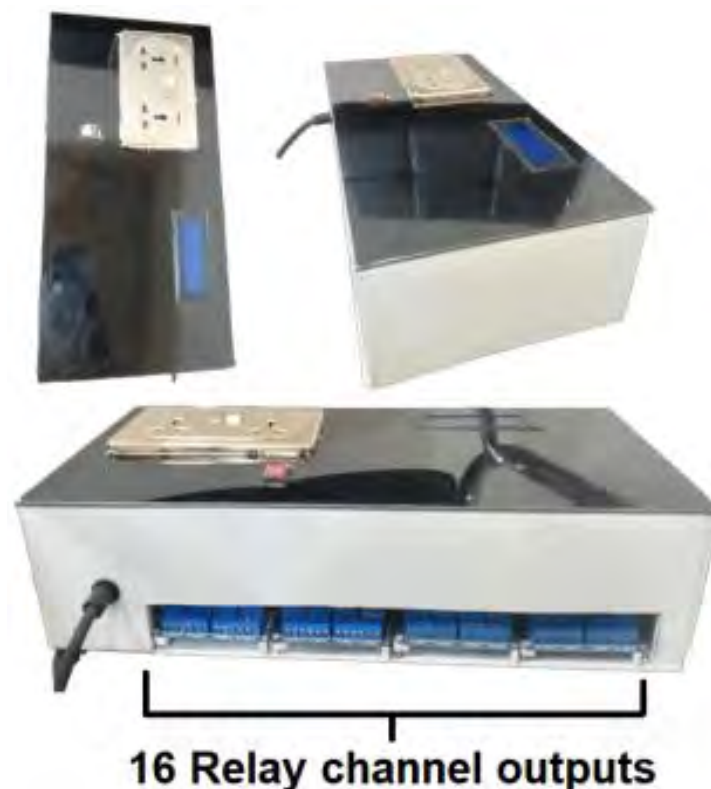
Рисунок 1.4. Загальний вигляд апаратного блоку «Homergy Vox» [2]
