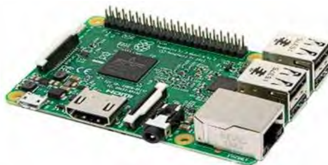
Рисунок 3.3. Зображення Raspberry Pi 3 [5, 7]
