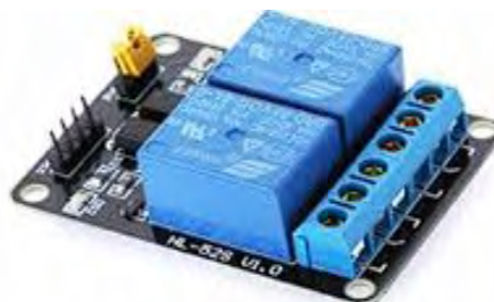
Рисунок 3.4. Зображення подвійного модуля реле [5]
