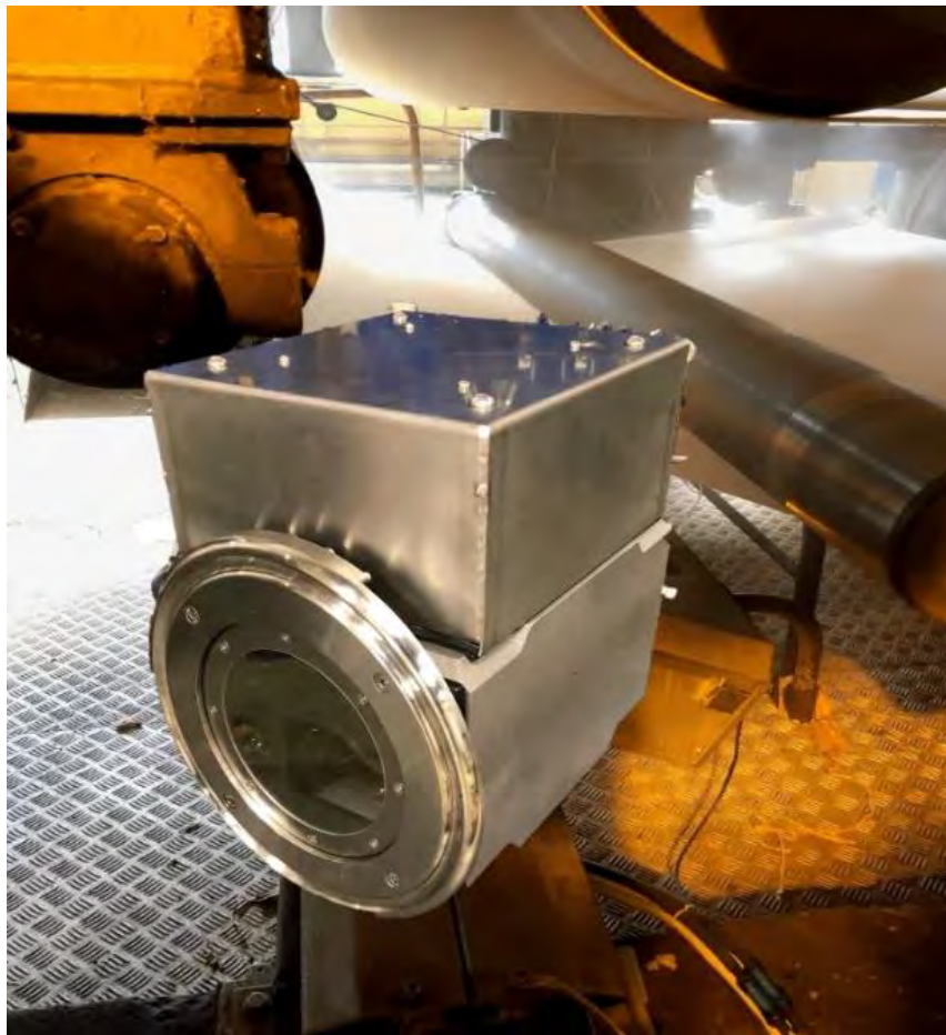
Рисунок 3.5 – Датчик Tasowheel Moisture IR Sensor
