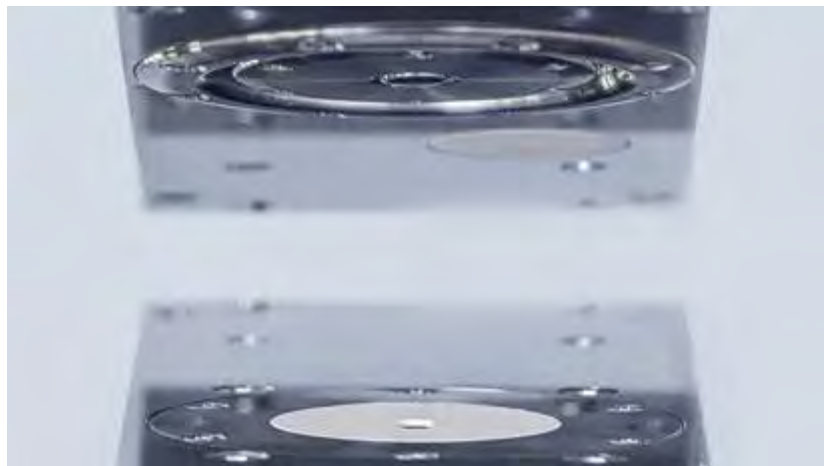
Рисунок 3.3 – Датчик Valmet IQ Basis Weight Measurement
