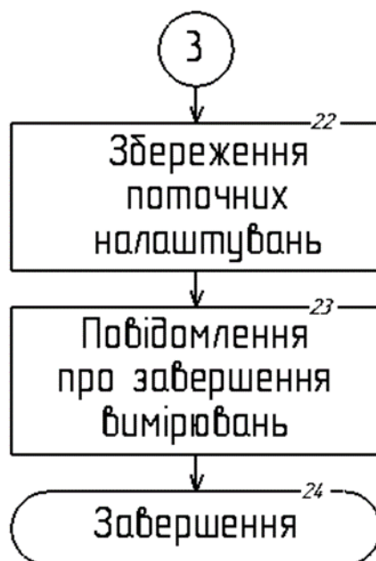
Рисунок 6.6. Фрагмент блок-схеми алгоритму, що ілюструє завершення циклу вимірювання
