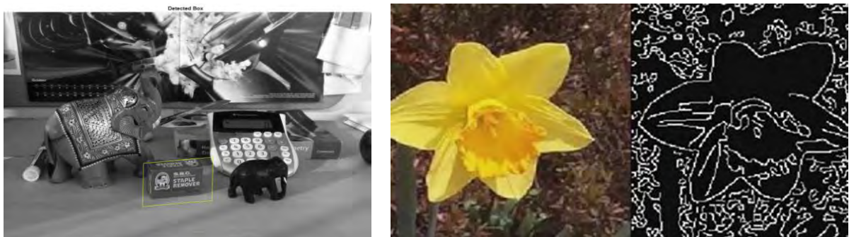
Рис. 19 Приклади роботи аналізу зображень: а) Знаходження певного об'єкта на зображенні серед інших предметів б) Визначення контурів
