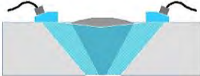
Рис. 1.15 - Покриття всього об'єму шва за один прохід
