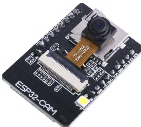
Рис. 3.1. Зовнішній вигляд апаратно-програмної платформи ESP32-CAM
