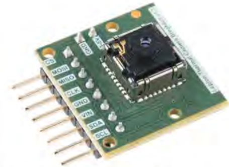
Матрична тепловізійна камера FLIR Lepton
