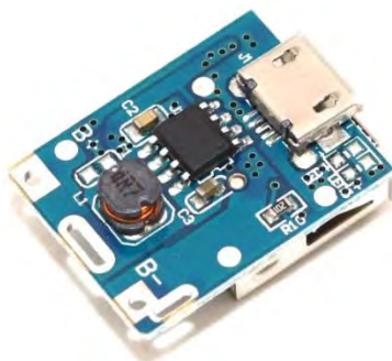
Рис. 3.4. Плата зарядки HT4928S з підсилювачем напруги
