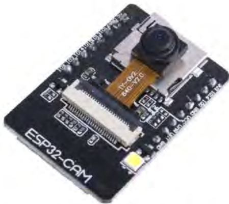
Програмно апаратна платформа ESP32-CAM
