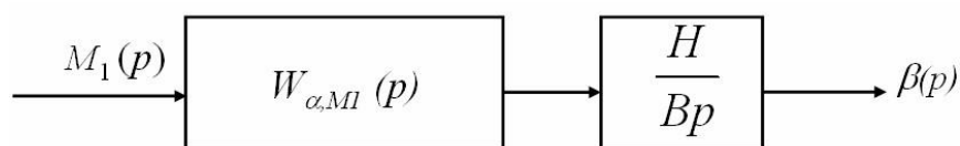
Рис. 2.10.. Перетворена структурна схема ( M_2=0 )
