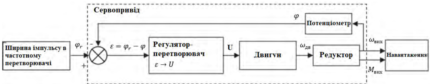
Рисунок 2.4 – Функціональна-структурна схема сервопривода
