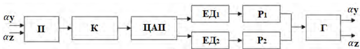
Рисунок 2.13 – Структурна схема системи автоматичного керування голівки КВМ
