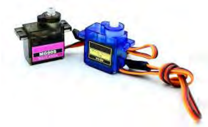
Рисунок 1.6 – Аналоговий та цифровий сервоприводи
