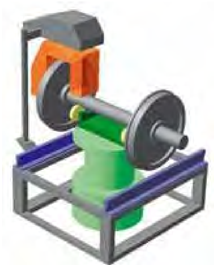
Рис. 1.1 – Автоматизований модуль системи вихрострумowego контролю колісних пар залізничних вагонів «PELENG-AUTOMAT»
