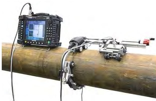
Рис. 1.2– Механізована система вихорострумового контролю труб.
