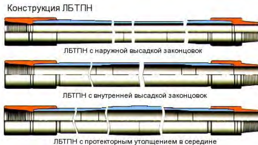
Рис.1.1 Конструкція легкосплавних бурільних труб підвищеної надійності з алюмінію (ЛБТПН)
