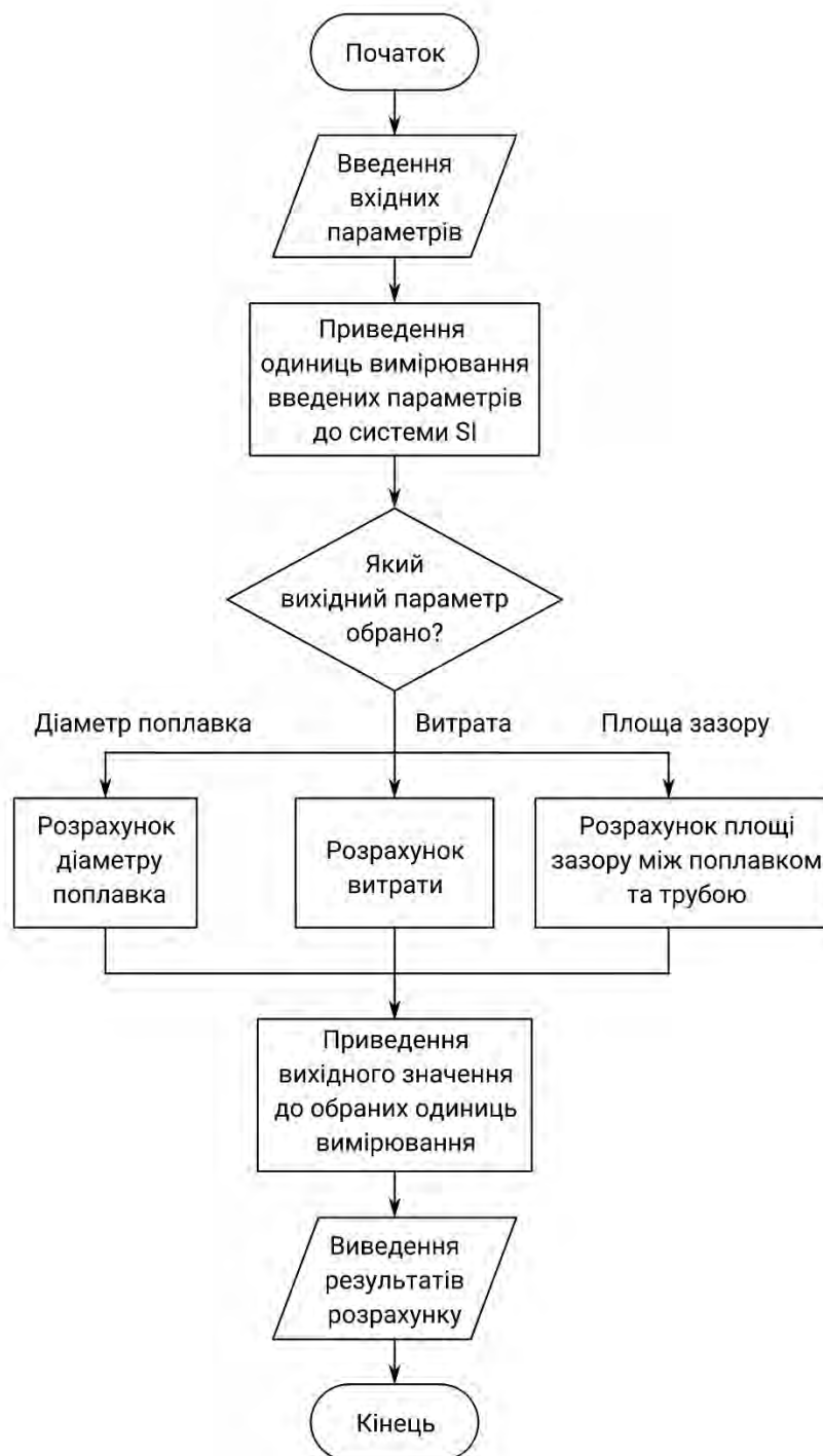
Рис. 4.31. Блок-схема алгоритму розрахунку ротаметру
