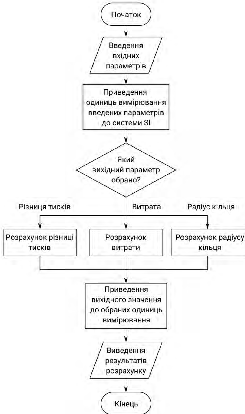
Рис. 4.24. Блок-схема алгоритму розрахунку кільцевого витратоміра
