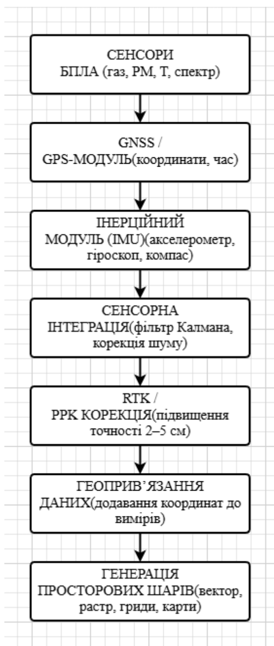
Рисунок 2.2 - Загальний процес просторової локалізації даних з БПЛА
