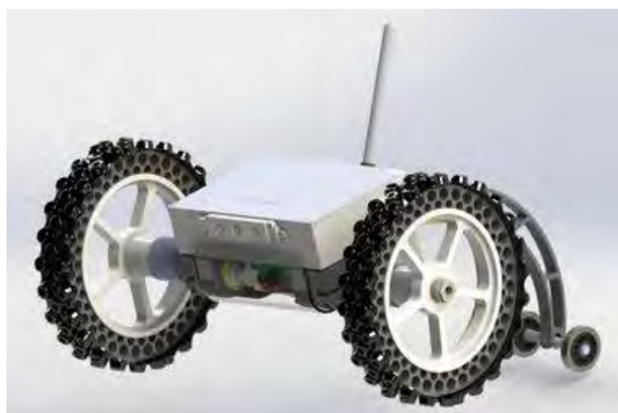
Рисунок 1.5 – 3D-візуалізація Magnet Crawler II (ескіз САD: Фелікс Бернхард, DFKI) [37]
