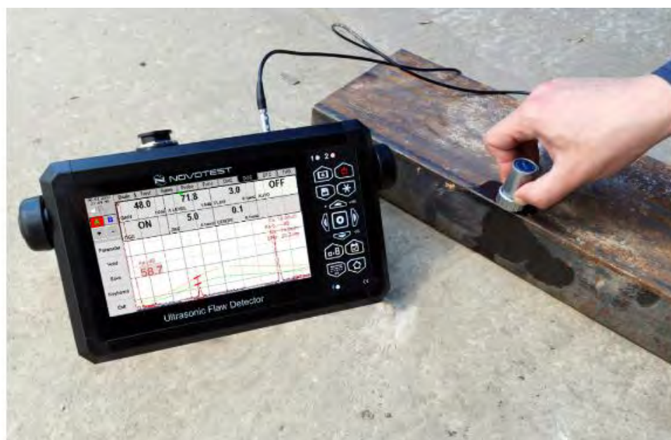
Рисунок 5.1 – Ультразвуковий дефектоскоп УД3701(NOVOTEST)
