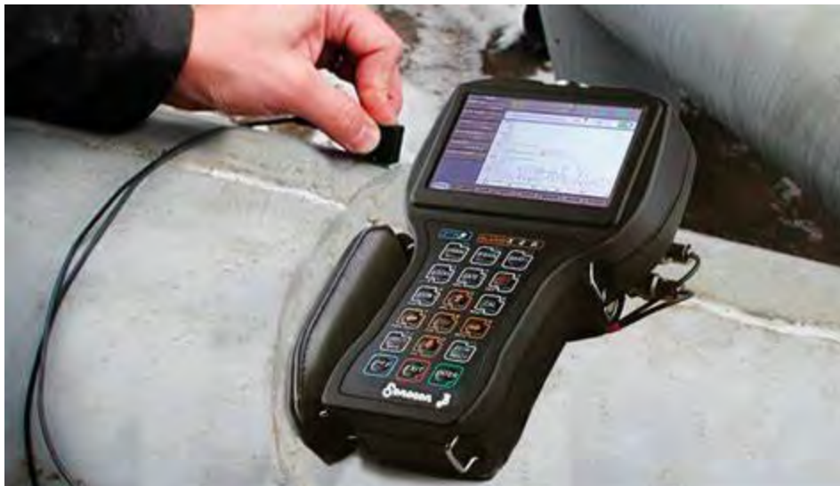
Рисунок 1.5 – Проведення ультразвукового НК.
