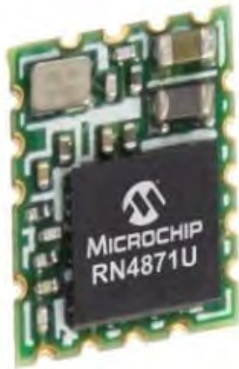
Рисунок 3.5 – Bluetooth модуль RN4871U
