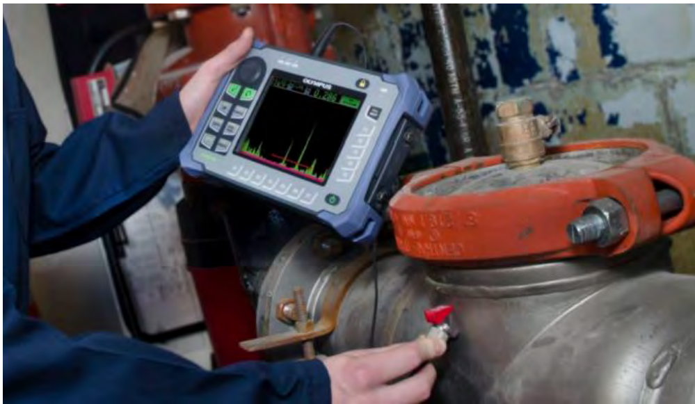
Рисунок 2.3 – Ультразвуковий дефектоскоп EPOCH 650
