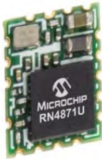
Рисунок 3.5 – Bluetooth модуль RN4871U
