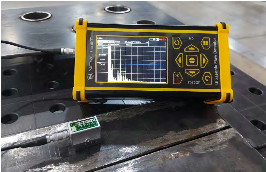
Рисунок 5.2 – Ультразвуковой дефектоскоп УД2303(NOVOTEST)
