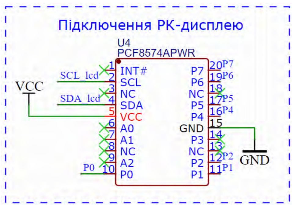
Рисунок 4.14 - Підключення перехідника РК-дисплею
