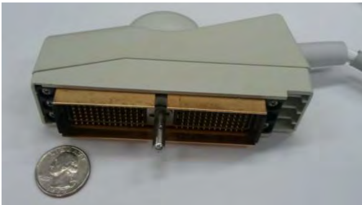
Рисунок 7. Звичайний конектор для підключення масиву перетворювачів (ФАР) до дефектоскопу.
