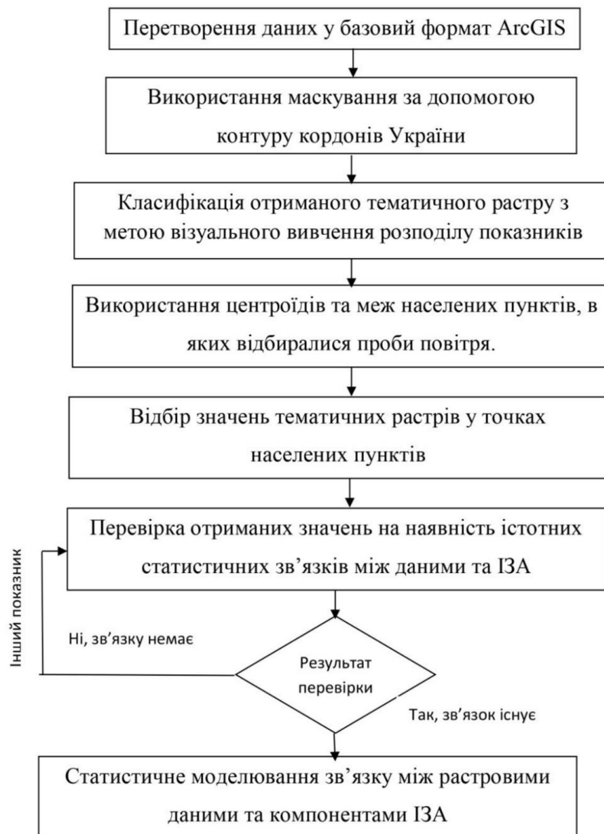
Рис. 1.6. Схема методики обробки даних ArcGIS [11]
