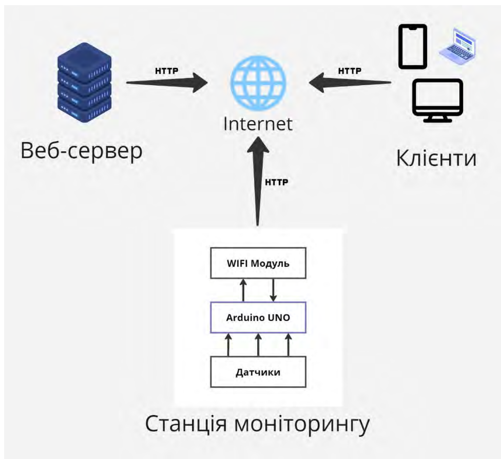
Рис. 2.1. Структурна схема системи віддаленого моніторингу стану навколишнього середовища
