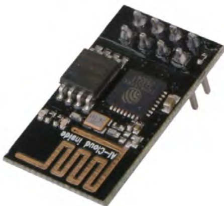
Рис. 2.7. Зовнішній вигляд модуля ESP8266 ESP-01
