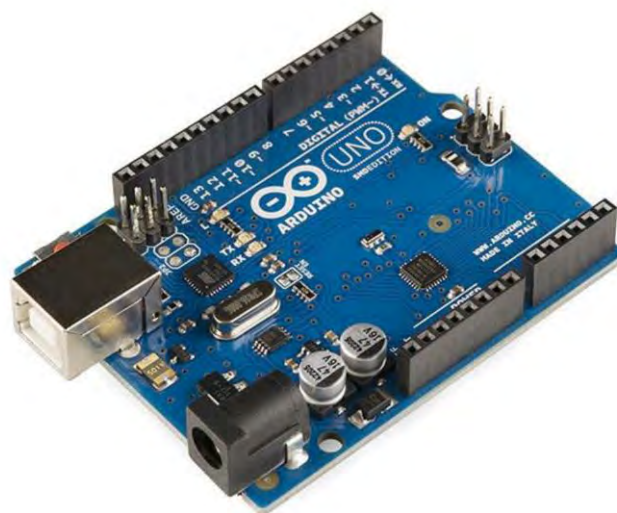
Рис. 2.5. Зовнішній вид плати модуля Arduino Uno
