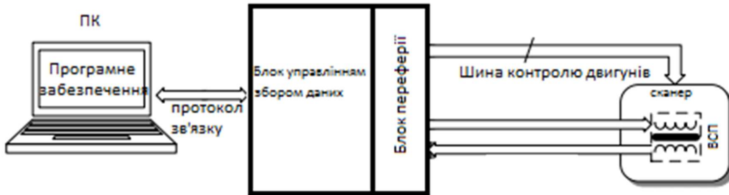
Рис.2.1. Структура системи автоматизованого вихрострумовеого контролю
