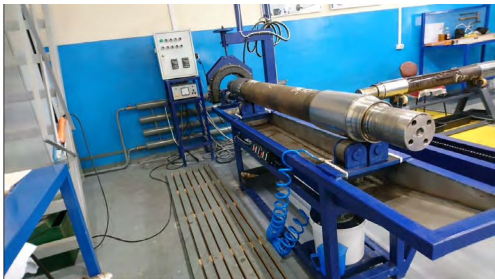
Рис.1.3. Магнітно-порошковий контроль осі колісної пари
