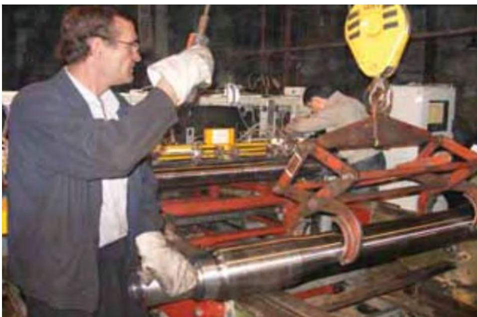
Рис.2.1. Встановлення осі на пост контролю
