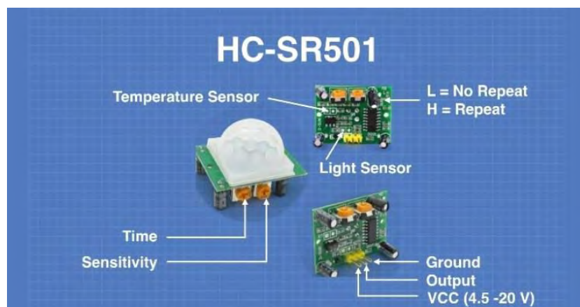
Рис. 2.19- Зображення PIR-датчика HC-SR501 та його будова
