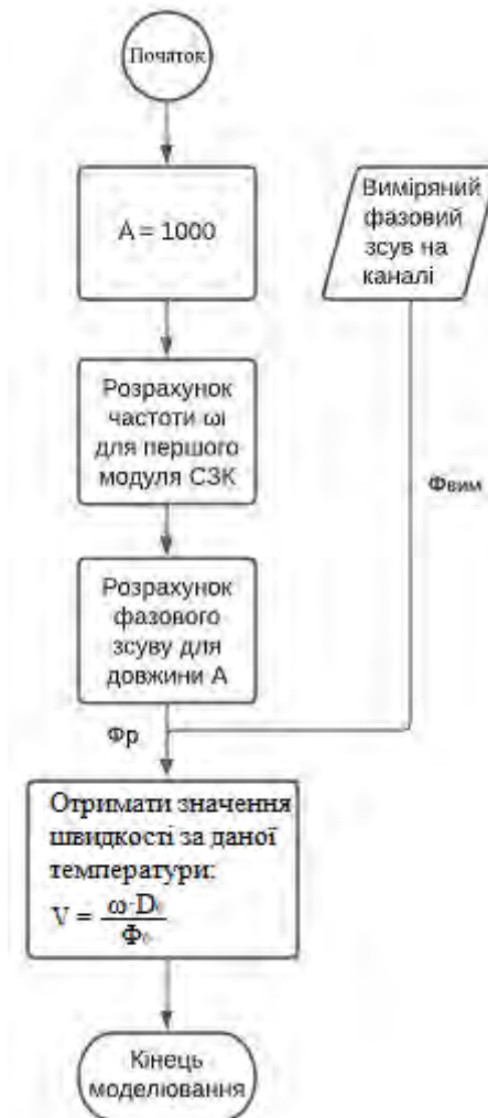
Рисунок 3.11. Блок-схема процесу калібрування системи координатної реєстрації положення датчика ВСНК по швидкості
