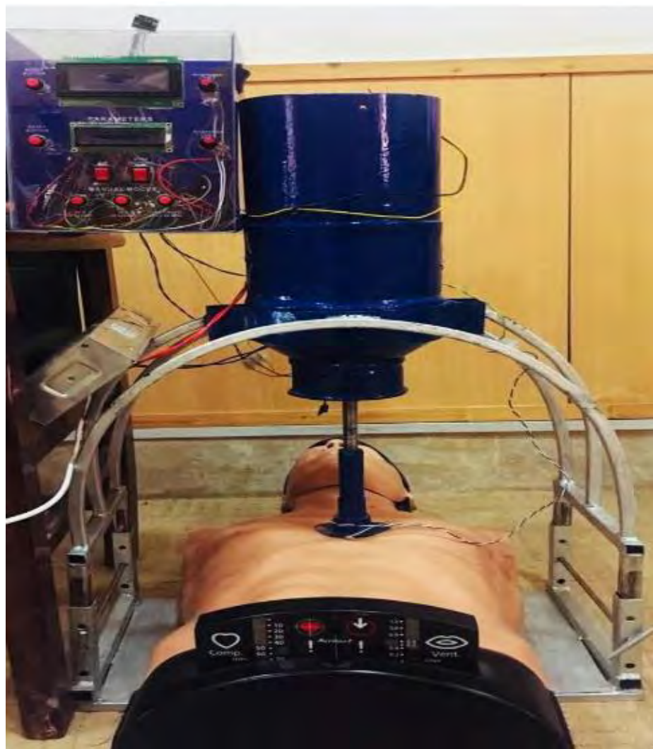
Рис. 1.4. Приклад системи автоматичного виконання СЛР з частковою участю рятувальників [18]
