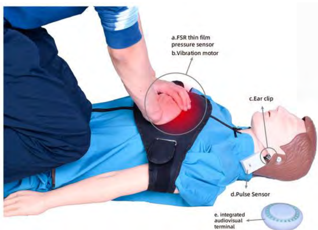
Рис. 1.5. Приклад системи автоматизованої оцінки СЛР у вигляді комплекту одягу для постраждалого
