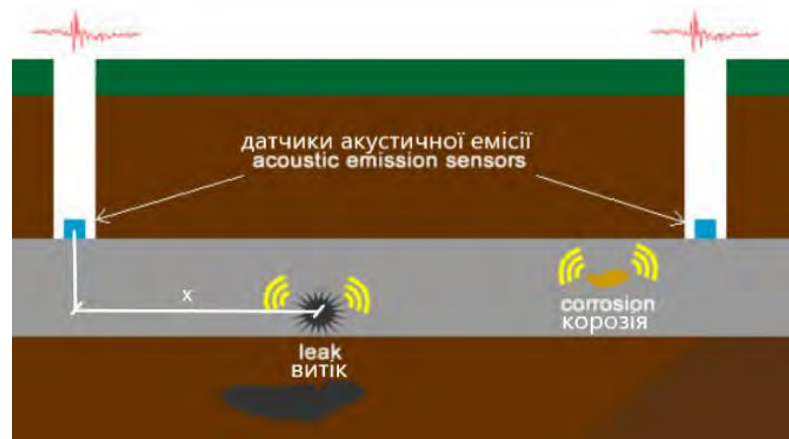
Рисунок 2.6. Схема проведення акустико-емісійного контролю [22].
