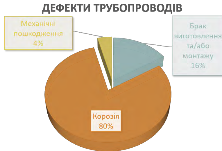
Рисунок 1.5. Причини виникнення дефектів у трубопроводі
