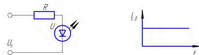
Рис. 1.1. Схема включення та часова діаграма режиму живлення постійним струмом
