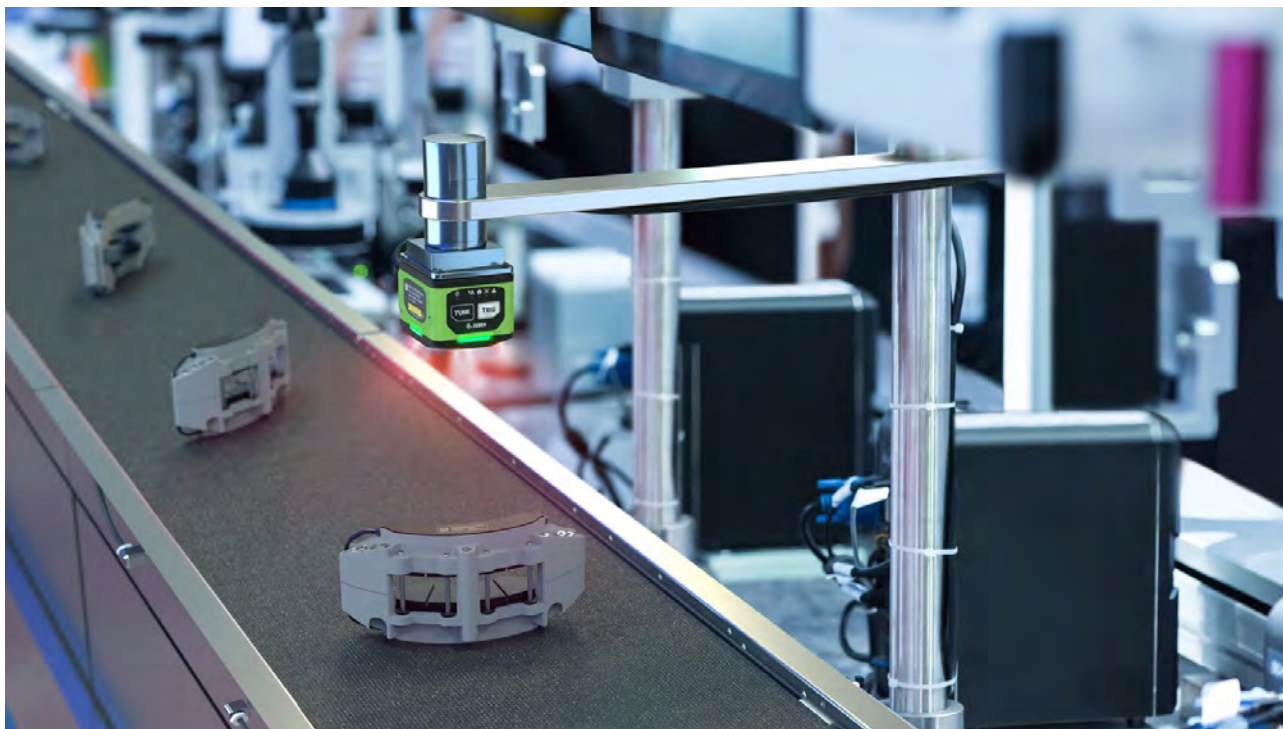
Рис. 1.6. Камери високої роздільної здатності в системі сортування [61]
