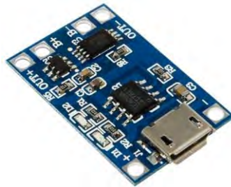
Рисунок 2.11 – Зовнішній вигляд модуля TP4056
