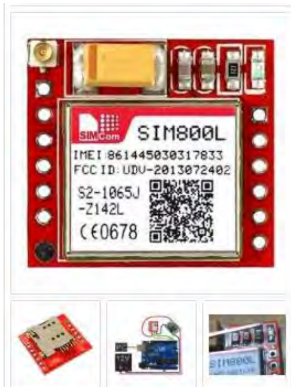
Рисунок 2.10 – Зовнішній вигляд GSM модуля SIM800L
