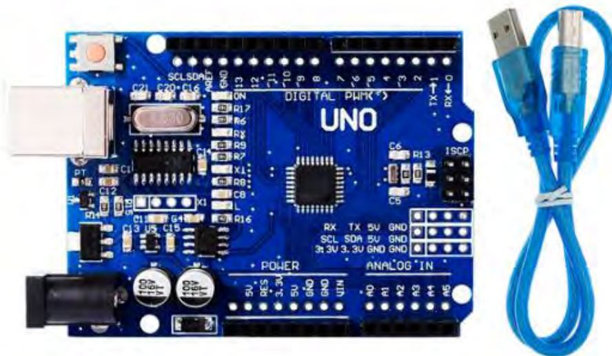
Рисунок 2.3 – Зовнішній вигляд модуля Arduino UNO
