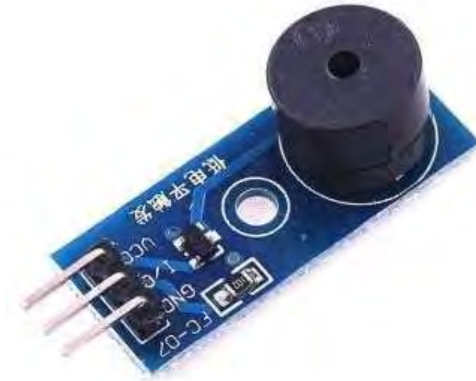
Рисунок 2.12 – Зовнішній вигляд модуля п'єзодинаміка
