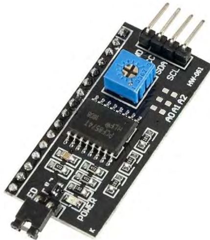
Рисунок 2.14 – Зовнішній вигляд модуля I 2 C
