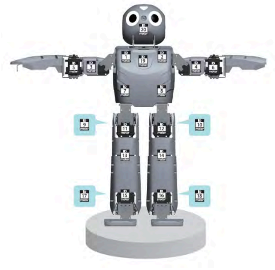
Рис 2.5.2: Положення моторів Darwin-Op
