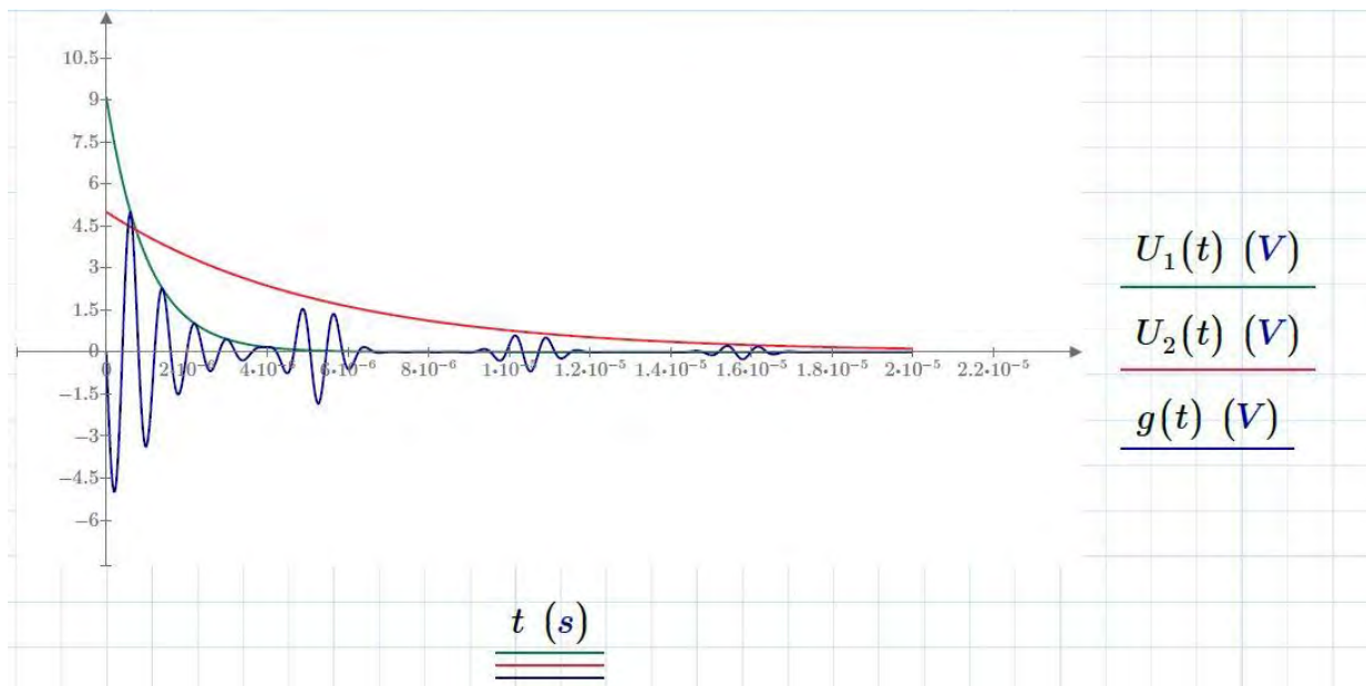
Рисунок 3.8. Модель імпульсу збудження з трьома луно імпульсами, що знаходяться на відстані 30mm, 60mm та 90mm відповідно
