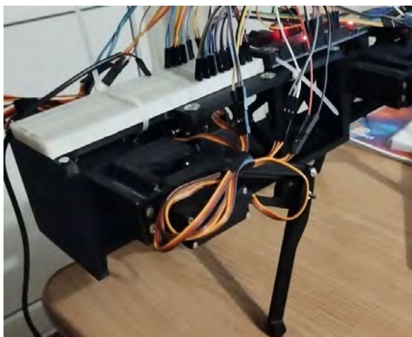
Рисунок. 5.3 - Фото прототипу збоку робота у максимальній висоті присяду
