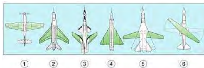
Рис. 2.1. Різновидність крил літальних апаратів: 1 – пряме, 2 – стрілоподібне, 3 – оберненої стрілоподібності, 4 – дельтоподібне, 5 – змінної стрілоподібності, 6 – косе [14].
