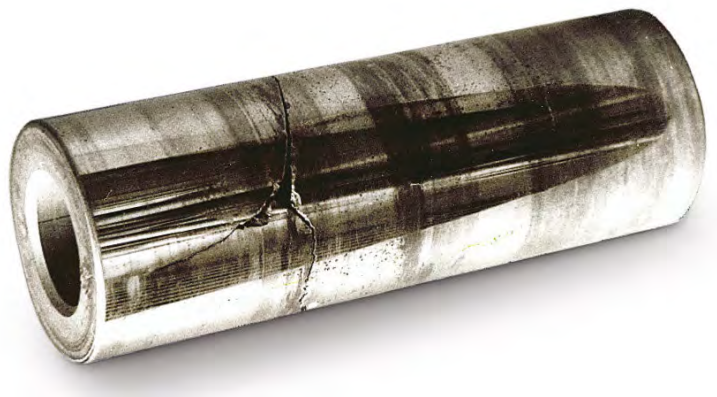
Рис. 1.4. Дефекти типу «тріщина»
