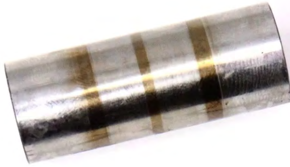
Рис. 1.6. Дефекти типу «перегрів»
