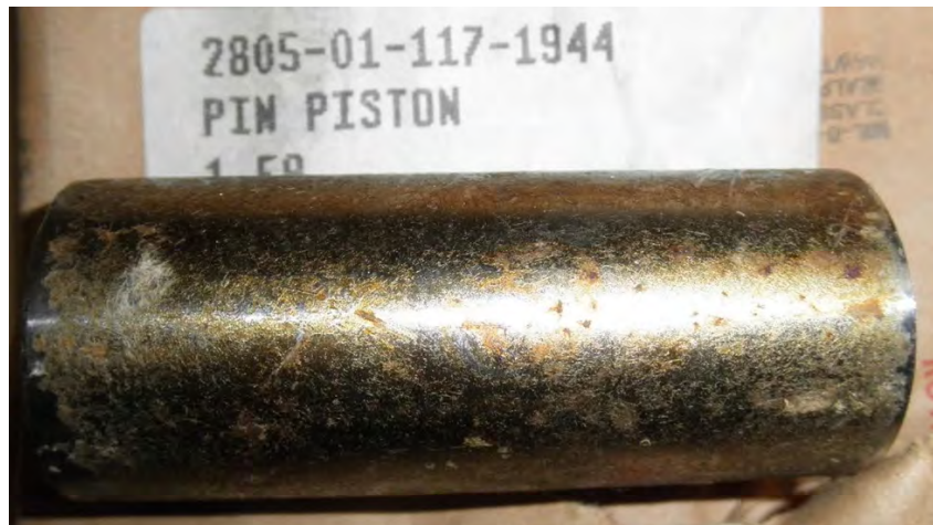
Рис. 1.5. Дефекти типу «корозія»
