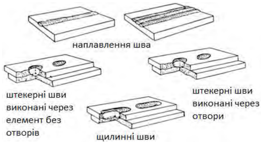
Рис. 1.5 Ілюстрації наплавлення, штепсельних і шліцевих зварювачів
