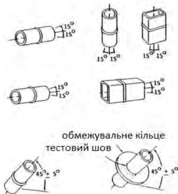
Рис. 1.6 Ілюстрації позицій зварювання труб
