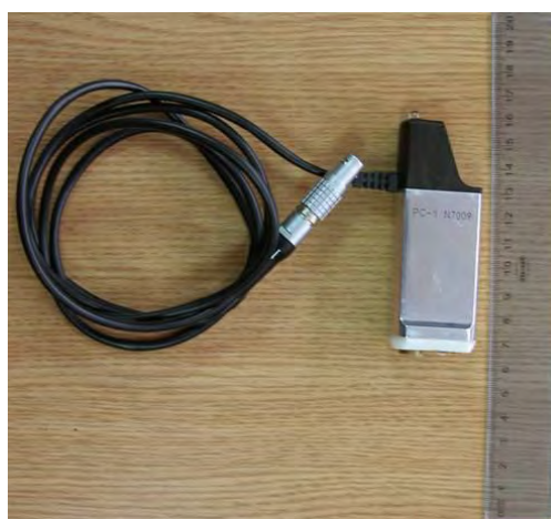
Рис.2.2 Фотографія перетворювача РС-1
