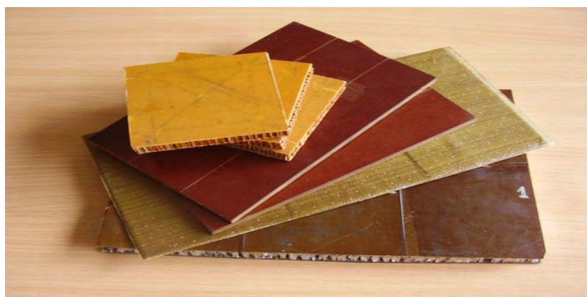
Рис. 1.2. Зразки матеріалів, з яких можуть бути виконані контрольовані конструктивні елементи
