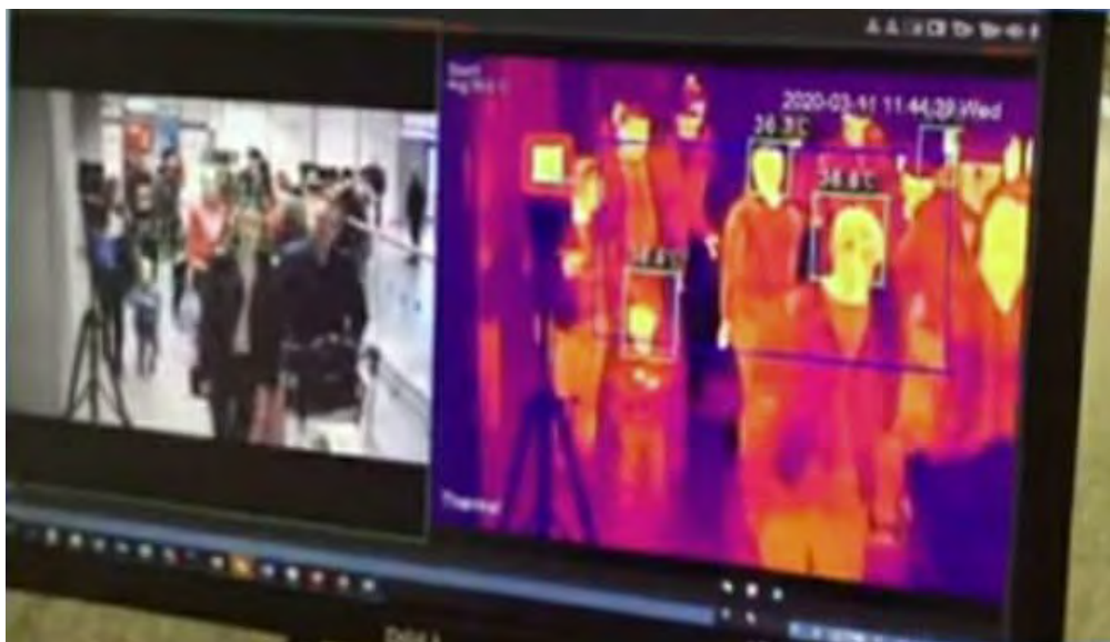
Рисунок 1.16 Інтерфейс програми для роботи з тепловізором Dahua
