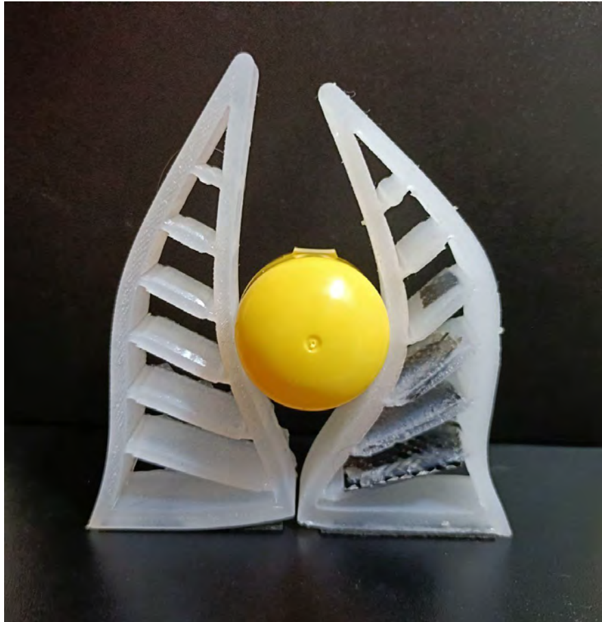
Рисунок 4.8. - Порівняння деформації базової конструкції з потовщеними граннями та зразка з армованими ребрами
