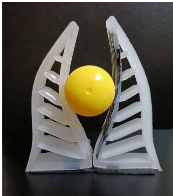
Рисунок 4.7. - Порівняння деформації базової конструкції з потовщеними граннями та зразка з інтегрованою вуглецевою тканиною у зовнішню грань.
