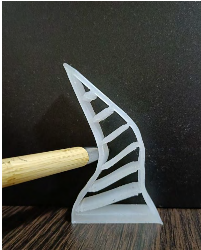
Рисунок 4.4. - Фото роботи захвату під навантаженням
