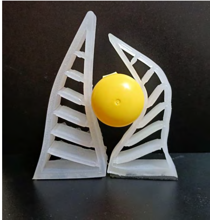
Рисунок 4.6. - Порівняння деформації базової конструкції без армування та зразок без армування, але зі збільшеною товщиною зовнішніх граней.
