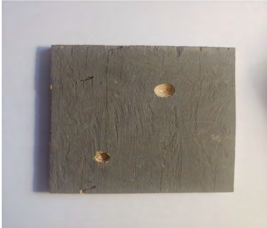
Рис. 4.2. Зразок ОК-1 має два на пів отвори глибиною 5 мм та діаметрами 14 та 10 мм відповідно
