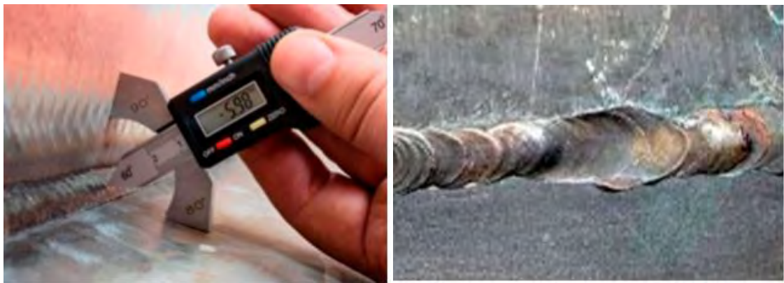
Рис.1.12. – Приклади застосування візуальних методів контролю
