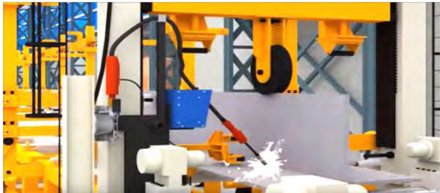
Рис. 1.22 – Таврове з'єднання двох листів металу
